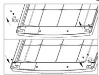
Heben Sie die Gerätetür aus dem unteren Scharnier. Versetzen Sie den Blindstopfen und die Blindkappe und stellen Sie die Tür sicher beiseite.
